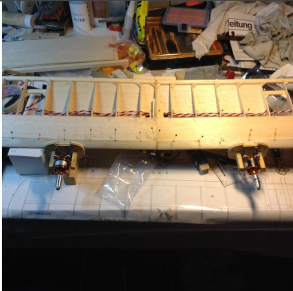
Fig.4c- La struttura dell'ala rivestita in balsa
